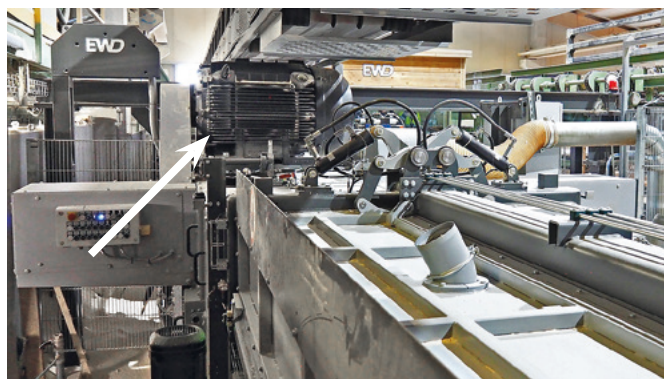
Aus Platzgründen hat EWD einen Motor an der BKO-6 oben angebracht, den anderen unten
