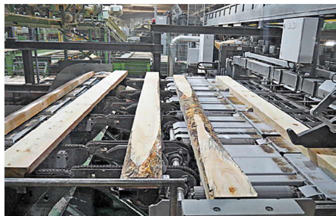
Die bis zu 120 mm starken Platten kommen auf den Ausrichttisch, links die Klappe zur Entsorgung, rechts die Messung von oben und unten
