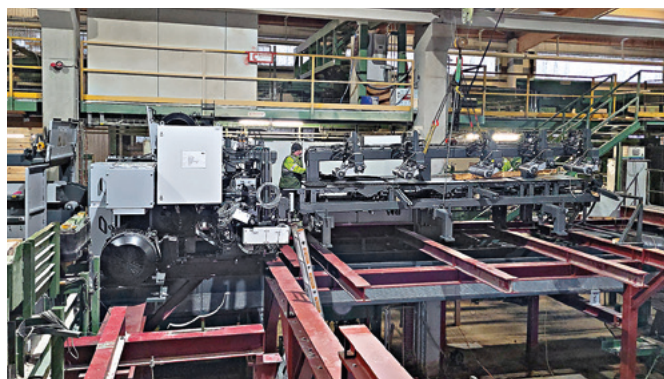
Während der Montage: EWD passte das Gewicht der Maschinenteile auf den vorhandenen Hallenkran mit maximal 5 t an
