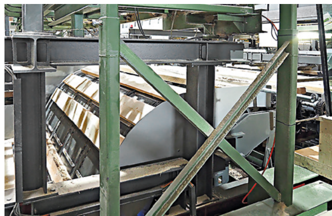
Millimeterarbeit: Blick auf die Vereinzelungsstufe in Richtung des Ausrichtisches vor dem Combimes – die grünen Stahlteile waren Bestand
