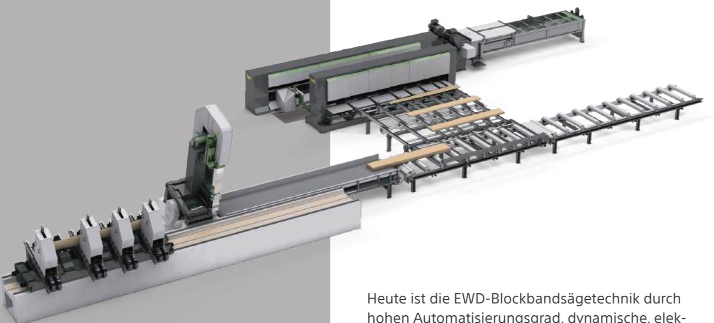
Heute ist die EWD-Blockbandsägetechnik durch hohen Automatisierungsgrad, dynamische, elektrische Antriebe, präzise Servopositioniersysteme, modernste Mess- und Optimierverfahren, Prozessprotokollierung und -visualisierung auch für den universellen Sägewerkseinsatz wirtschaftlich attraktiv.
