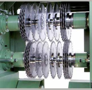
La scie circulaire flexible double arbre VNK est utilisée comme machine de précoupe, de reprise ou en combinaison des deux dans les scieries de moyenne et grande production. Au total, 6 paires de manchons peuvent être positionnées avec précision via des servosystèmes hydrauliques.
