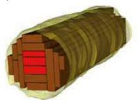
L'alignement des noyaux s'effectue également, après le mesurage 3D et l'optimisation des schémas de coupe, diagonalement ou parallèlement à l'axe du système. Pour augmenter le rendement, le système ZE 2 permet également le sciage de schémas de coupe asymétriques, retirant ainsi le maximum de chaque billon ou noyau.
