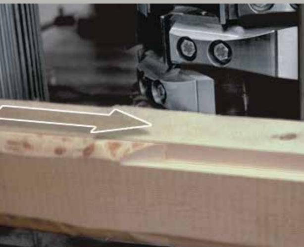
Für die individuelle, optimale Seitenbrettausbeute wird die FR 15 S auch für die Diagonal-Profilierung eingesetzt. Die Profilerwerkzeuge werden dabei für jedes Seitenbrett individuell, entsprechend den Vorgaben von 3D-Scanner und Optimierer, positioniert. Die präzise Bahnsteuerung der Werkzeuge ermöglicht die Erzeugung maximaler Ausbeute unter Berücksichtigung der gegebenen Waldkantenregeln.
