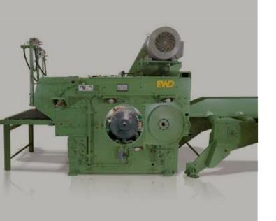
Die handbeschickte Besäum- und Nachschnittanlage DK 90 ist die perfekte Ergänzung zu den Hauptmaschinen wie Gatter oder Blockbandsäge im kleinen Sägewerk.
