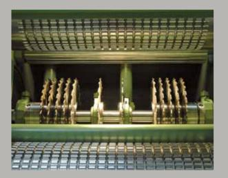
Der Combimes ist durch die Vielzahl der damit kombinierbaren Besäum- und Nachschnittkreissägen für verschiedenste Produktionsaufgaben einsetzbar.
