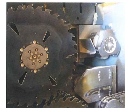
Zentrier- und Einzugsstisch ZE2, Spaner PF 19 und flexible Doppelwellenkreissäge DWK/6 mit Schutzfräser für die Sägewellen (v. li.), zudem gibt es noch eine Kappsäge für die Seitenware
