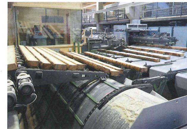
Zuführung zur Optimes-Besäumkreissäge: Am oberen Deck gelangt die Hauptware zur Anlage, von unten kommt die Seitenware vereinzelt zum Manipulationstisch
