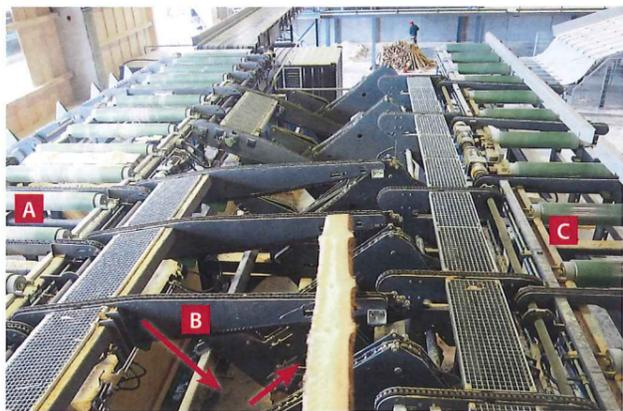
Eine Besonderheit: Von links kommen die Model aus der Kreissäge (A) und werden mehrstufig geschnitten. Der Querförderer (B) lässt sich absenken und die Stücke werden für den Rundlauf (C) vereinzelt
