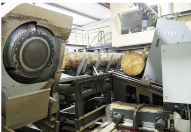
Der Spaner ist mit einem 110 kW starken Motor ausgerüstet und schafft auch große Durchmesser mühelos
