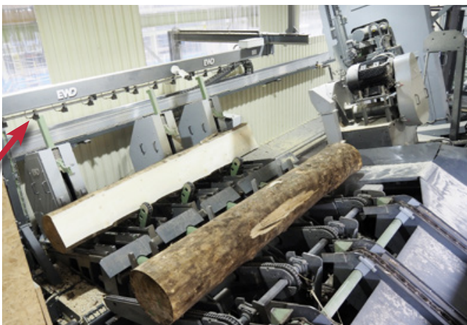
Ein Laserbalken ermittelt die Dimension, sobald der Stamm am Spannwagen liegt
