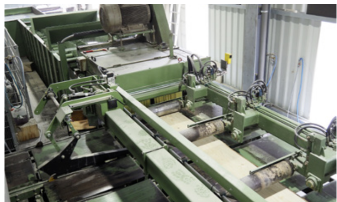
Ebenfalls von EWD: Die gebrauchte Combimes-Besümanlage wurde von Vecotrade technisch weitestgehend überholt
