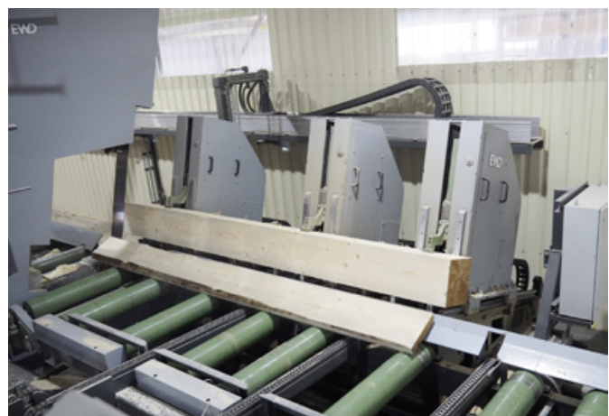
Vorteil der geneigten Bandsäge: Auslaufseitig gleiten die Produkte sanft auf einen Rollengang ab
