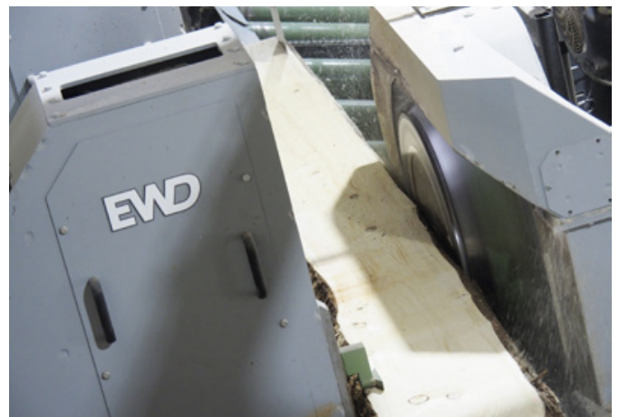
Ein Spaner zerspannt die Störschwarten vor der Bandsäge – das erleichtert den Ablauf und führt zu einer reibungslosen Produktion
