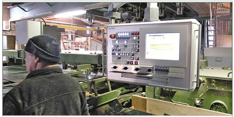
Besäumenanlage nach dem Umbau, im Hintergrund die unveränderte EWD-Nachschnittsäge „BK-100T2“, Baujahr 1989. Fotos: J. Härer (5)
