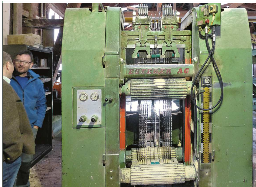
Inhaber Peter Lippuner (rechts) im Gespräch mit EWD-Techniker Alois Deser neben der Hauptmaschine, einem Esterer-Gatter (Modell „HDE-S/SV“, Bj. 1991)
