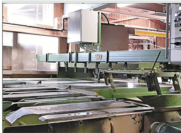
Neuer Messbalken mit 11 Laser-Messeinheiten, Länge 6,4 m
