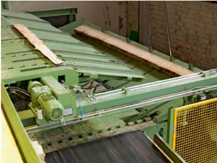
Über ein zweites Deck , welches gleichzeitig als Puffer dient, können auch Model dem Besäumer zugeführt werden
