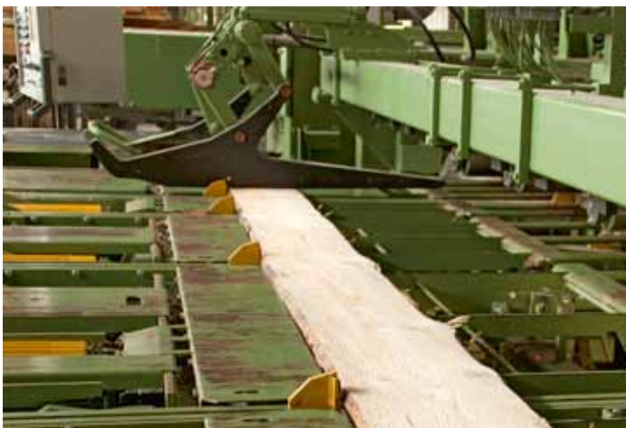
Einzugstisch vor dem Besäumer: Die Seitenware (oder Model) wird bei Bedarf gekappt, im Querdurchlauf vermessen und dann aufgetrennt
