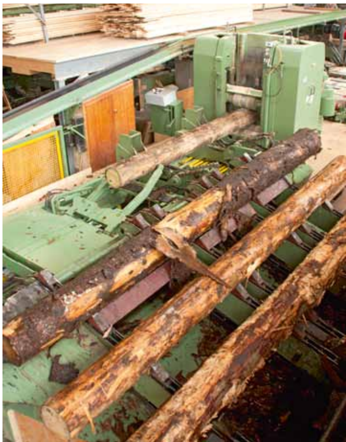
Bewährte Technik, neue Maschine: Im Sägewerk Karl Zehnder ist ein USF-Schnellspanwagen mit HDN-Gatter im Einsatz
