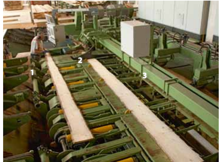
Manipulationsbereich: Der Mitarbeiter scheidet die Schwarten aus (1), kappt die Enden (2), danach geht es in die Quervermessung (3)
