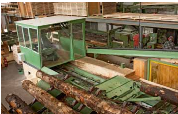
Sauberer Arbeitsplatz: Der Einschnitt am Gatter wird von einer Kabine aus mit moderner Joysticksteuerung durchgeführt
