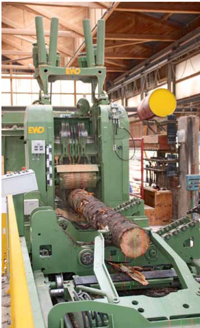
Das GDZ-Gatter mit Vario SV 4-Breitenverstellung ist seit wenigen Wochen bei Innoholz im Einsatz
