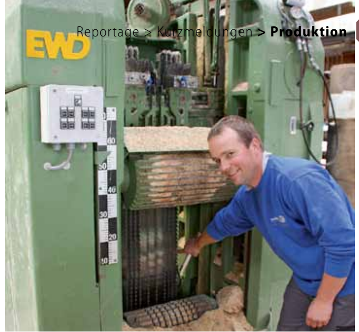
Pirmin Fischbacher zeigt auf den Einhang mit der Breitenverstellung Vario SV4: „Ohne diese geht's bei uns nicht.“
