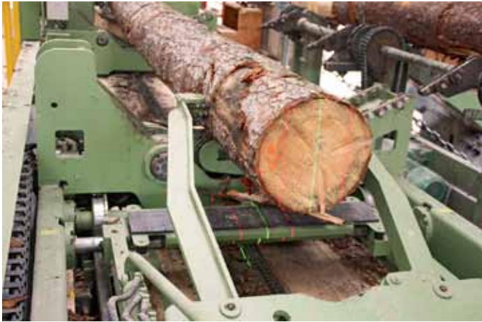
Ebenfalls neu: der ferngesteuerte Schnellspannwagen USF, den EWD vor zwei Jahren auf den Markt brachte
