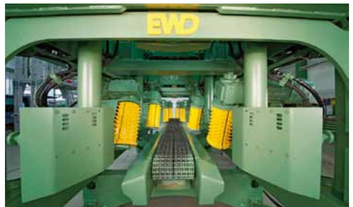
Zentrier- und Einzugsstisch ZE-2 dreht und positioniert Stämme und Model nach dem optimalen Schnittbild
