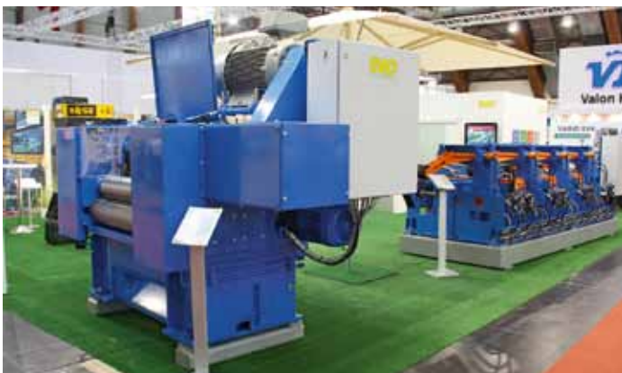
Die Besäumkreissäge BKO mit dem System Opti550 für über 20.000 Bretter pro Schicht wird demnächst in Südafrika installiert
