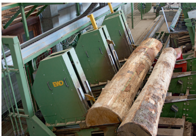
Der Spannwagen vor der Blockbandsäge ist mit vier einzeln verstellbaren Spannböcken ausgerüstet
