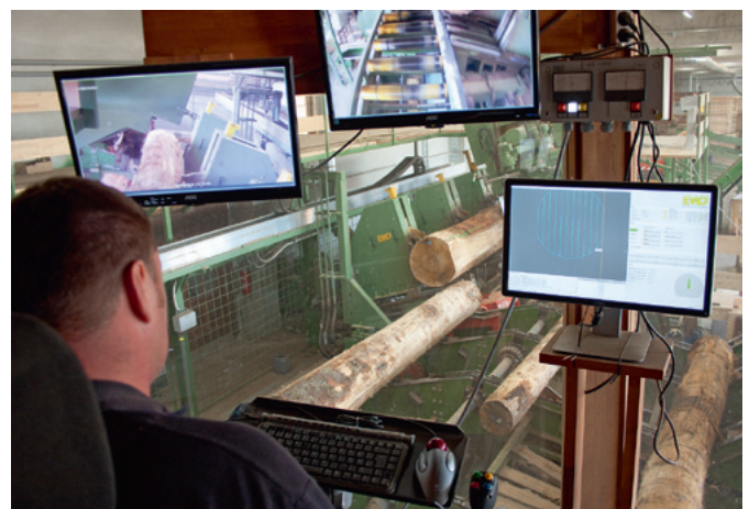
Der Mitarbeiter hat von seiner Kabine aus die Schnittfläche gut im Blick und überwacht mittels Bildschirmen die gesamte Anlage
