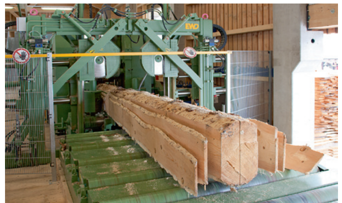
An der Auslaufseite des Gatters installierte EWD Kreissägen, um die Seitenware gleich kappen zu können
