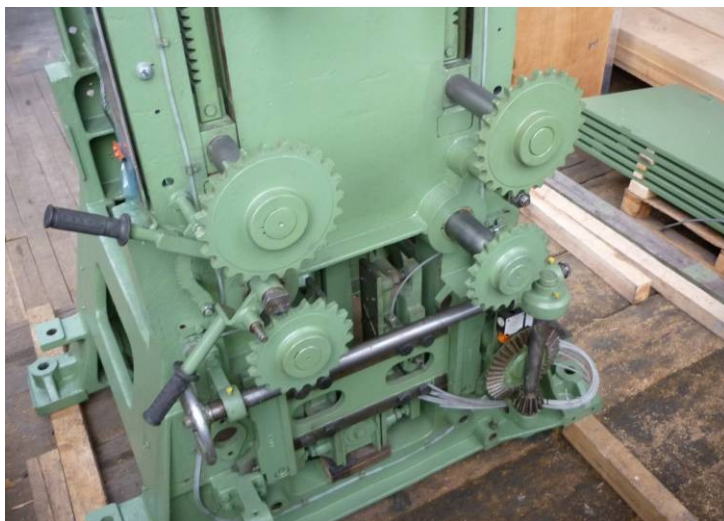
Hebel für Bremse- und Ausrücker, Walzenantrieb
