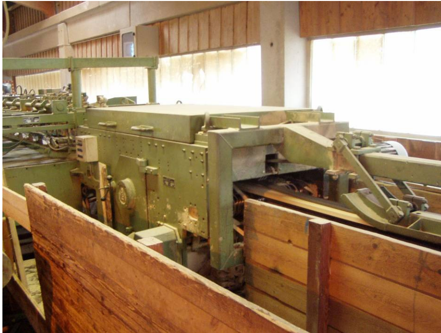
BK50 Besäumkreissäge, ASV Spreißelabscheider
