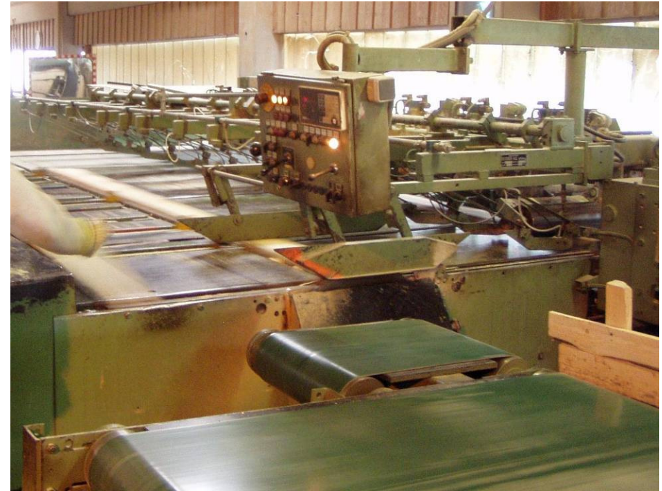
Manipulation, Einzugstisch, Bedienpult, Stützförderband
