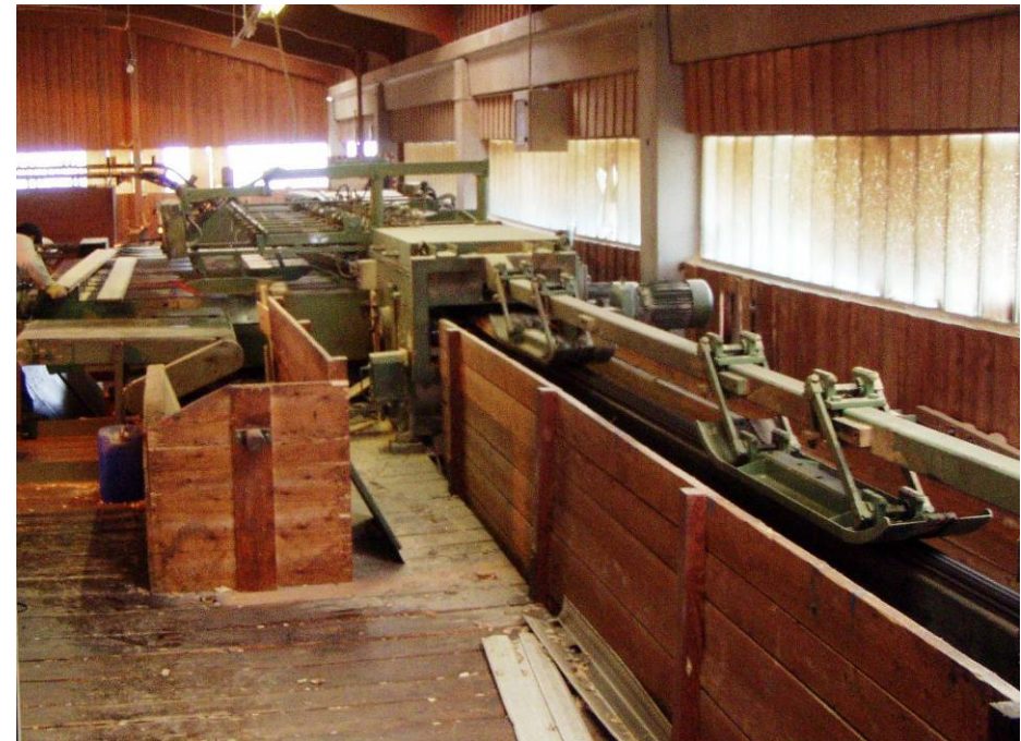
Manipulation, Einzugstisch, BK50 Besäumkreissäge, ASV Spreißelabscheider
