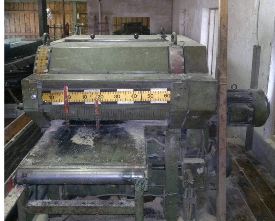
DKV_2c Kreissäge mit Antriebsmotor 22 kW (Einschnittseite)
