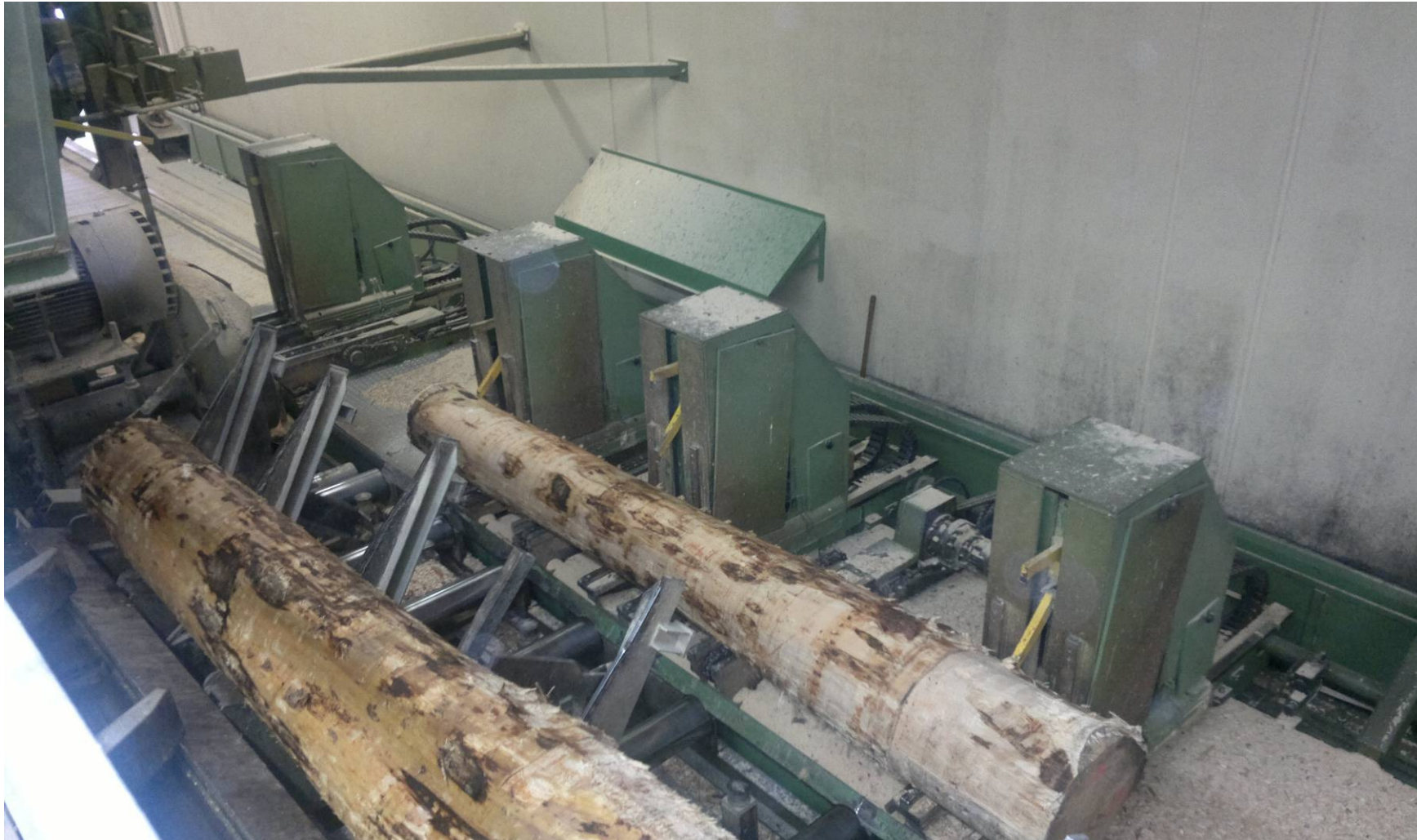
EW1200-5-4 Blockbandsägewagen, Einschnittseite (Zerspaner im Lieferumfang nicht enthalten!)
