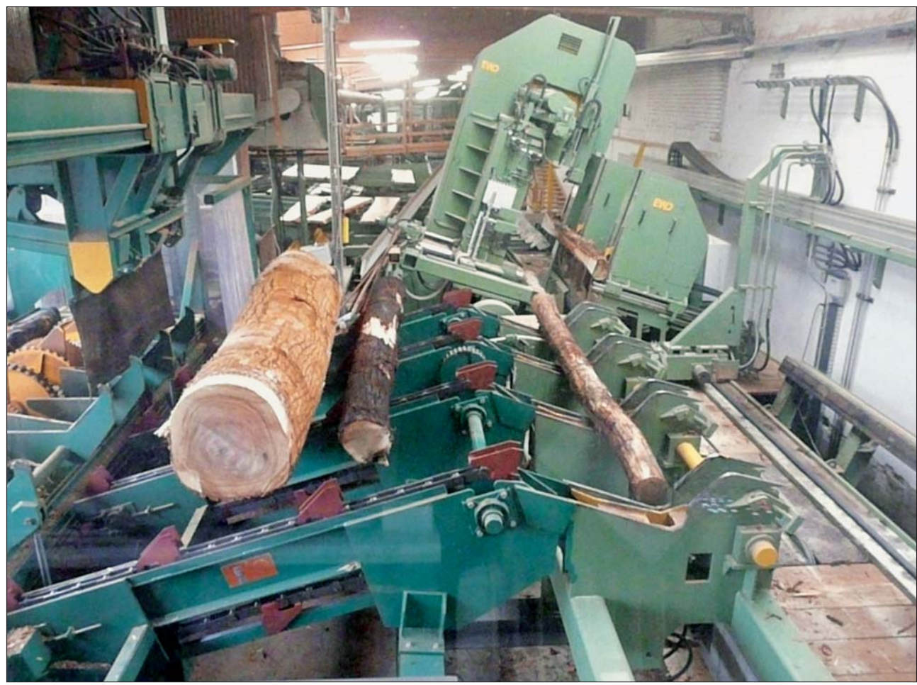
Bei Lüffe Baak wird der ganze Pappelstamm verarbeitet: Zu Demonstrationszwecken wurden hier sowohl sehr dicke als auch ganz dünne Abschnitte auf die Bandsägenanlage aufgelegt. Die kleinen Dimensionen werden normalerweise am Gatter aufgetrennt.
