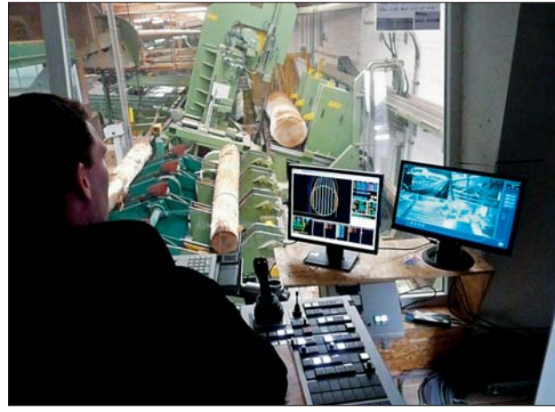
Wagen-Positionierung, Vermessung, Schnittbildvorschlag – das alles übernimmt die EWD-Anlage, der Sägenführer muss weniger steuern und kann zusätzliche Überwachungsaufgaben übernehmen.
