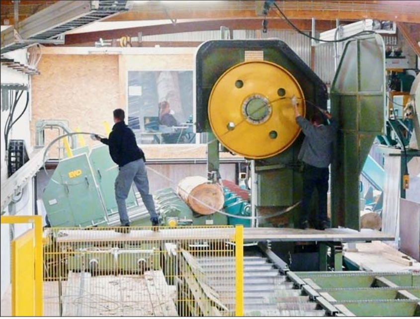
Blattwechsel vom schwenkbaren Podest aus. Wegen der Senkrechtstellung kann er mit zwei Mann (statt früher mit dreien) durchgeführt werden.
