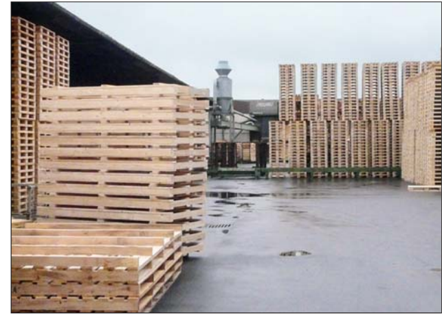
Die Vortrocknung der aus frischen Pappelzuschnitten produzierten Paletten an der Luft ist Voraussetzung für eine kurzfristige Auslieferung der Ware innerhalb von zwei Tagen. Die Nach Trocknung erfolgt in ölbrennerbeheizten Kammern.
