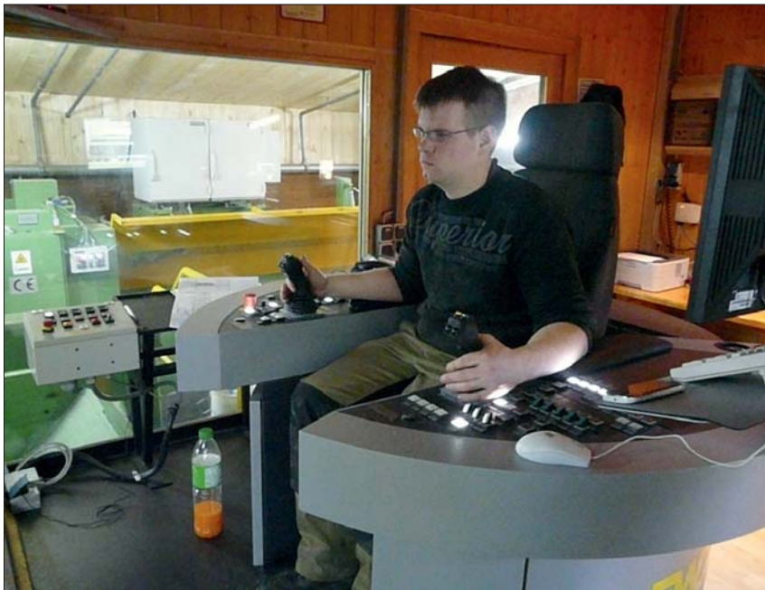
Das Säumer-Bedienpult ist drehbar gelagert. Der Bediener kann je nach Bedarf seine Haupt-Blickrichtung auch nach rechts oder links schwenken.
