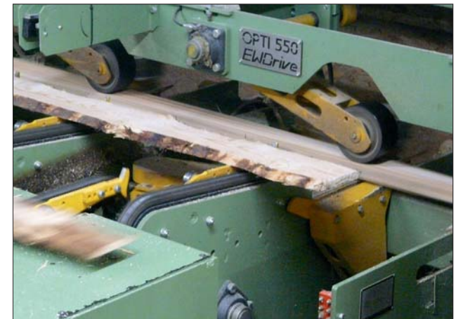
Während das beschleunigte Brett – von den oberen Andruckrollen auf das Kettenbett gedrückt – nach rechts in die Vermessung einfährt, liegt das nächste Brett schon bereit, gehalten von den Kaskadenhaken.
