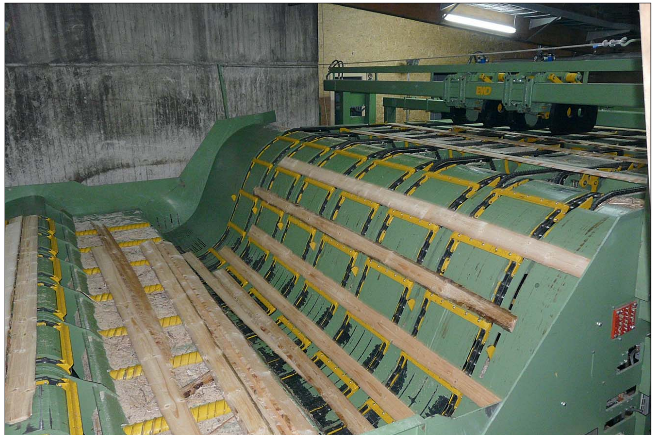
Der S-Förderer der Entzerrstufe vor der Brettervereinzelung und Säumer-Zuführung (rechts oben) kann für verschieden breite Sortimente in seiner Neigung verstellt werden. Fotos: L. Pirson
