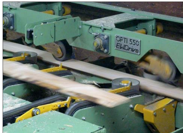
Im Bild sichtbar die zwei seitlich des Bretts angeordneten Beschleunigungsrollenpaare, die sich gleich weit öffnen, um den Platz für das herankommende nächste Seitenbrett frei zu machen.
