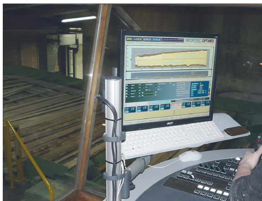
Visualisierung des Besäumvorgangs und Ausbeuteberechnung mit dem Optimes-System von Microtec.
