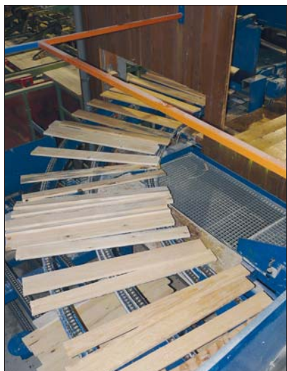
Palettenbretter in der Standardlänge 1,2 m auf dem Bogenförderer vom Säumer kommend auf dem Weg in die Brett-sortierung
