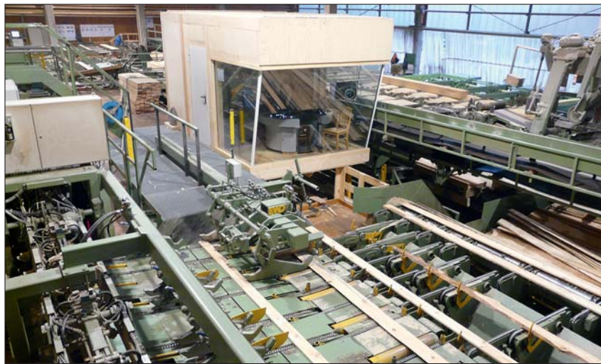
Neue Säumerzuführung mit Leitstand: Links der Säumer, rechts die Sägelinie
