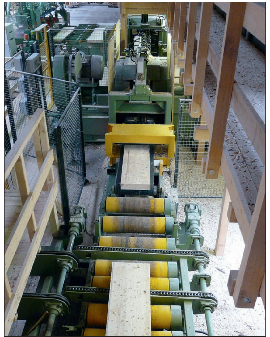
Palettenbrettrohlinge auf dem Weg von der Querkappung (links oben) über Vereinzelung, Vermessung und Besäumspanereinheit (Mitte hinten) zur Nachschnittsäge (nicht im Bild). In Bildmitte ein Metalldetektor (gelb), der das Holz vor dem Nachschnitt auf Einschlüsse prüft. Fotos: L. Pirson
