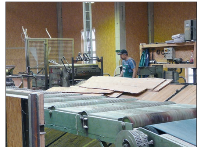
Am Ende der Vorschnitt-Rollenbahn: Zuführung der Seitenwarenbretter zum handbeschickten Säumer
