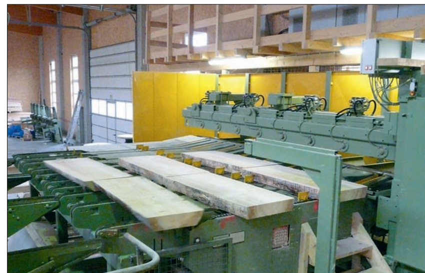
Übergabestation der grob vorgekappten Palettenholzrohlinge vom Quer- in den Längstransport und in die Vermessung.
