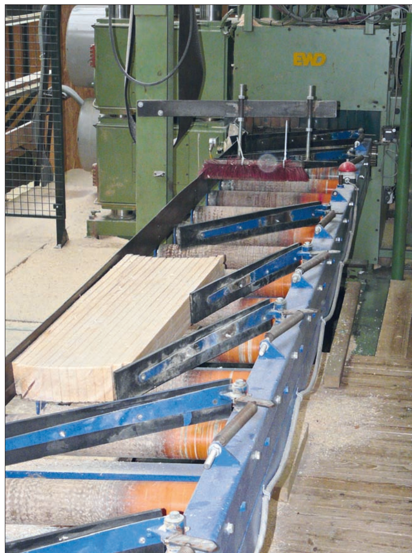
Palettenbretterzeugung mit Hochleistung: da kommt richtig Menge. In der Nachschnittsäge ist ein Einhang bis zu 32 Sägen möglich, normal sind es 20 bis 25.
