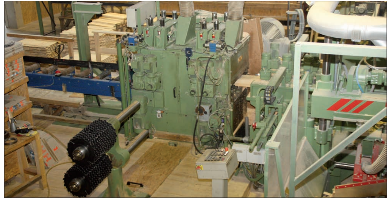
Die Nachschnittsäge von der Seite mit Sägenflansch-Schnellwechseleinrichtung
