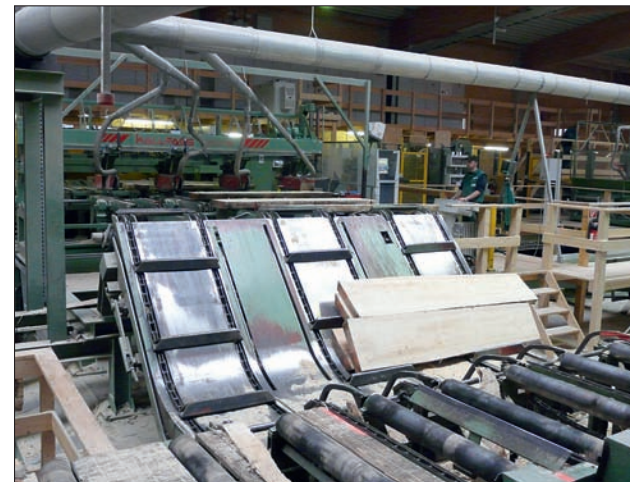
Stufenvereinzelung der Hauptware vor der Mehrfach-Querkappanlage
