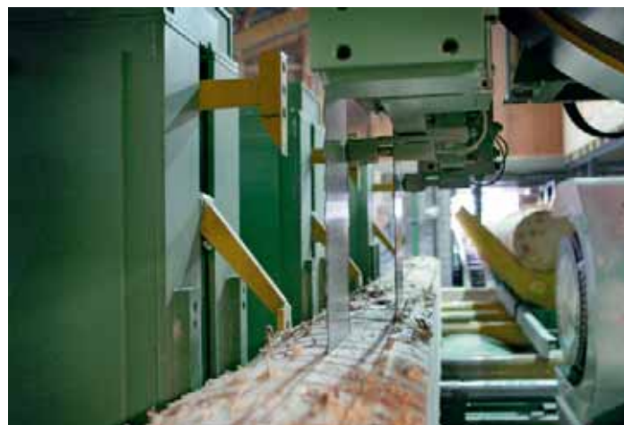
Detail des Tandem-Schnittes: Spaner PF 19 (rechts im Bild) erzeugt vor dem ersten Schnitt eine plane Fläche
