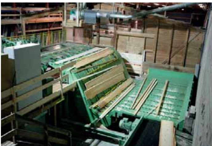
Neuer S-Förderer für kontinuierliche Zubringung der Seitenware wurde vor dem Optimes-Besäumer installiert
