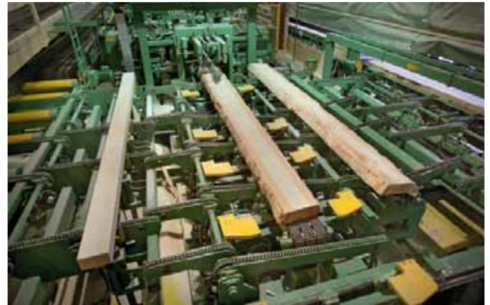
Einzug in die Doppelwellen-Nachschnittkreissäge VNK300: von rechts kommen Model von der Bandsäge, von links die Hölzer aus dem Rundlauf
