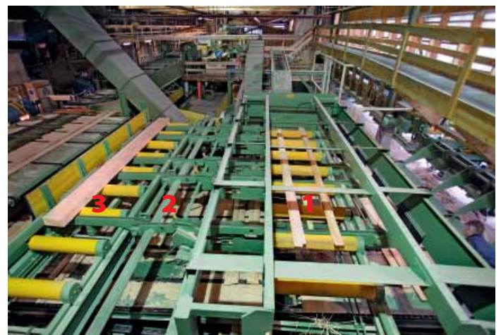
Verteilstation hinter Abscheider: 1 Abzug hinter ASV, 2 Klappe zum Ausschleusen der fertigen Lamellen/Kanteln, 3 Rundlauf
