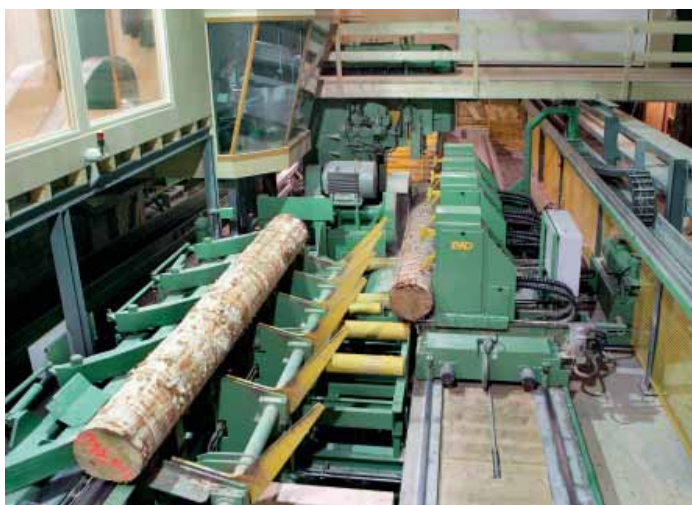
Tandem-Blockbandsäge für Vor- und Rückwärtsschnitt von EWD bei Olwo – die Technologie ist patentiert
