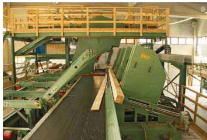
Durch die schräge Ausführung gleitet die Schnittware sanft auf die Förderbänder ab
