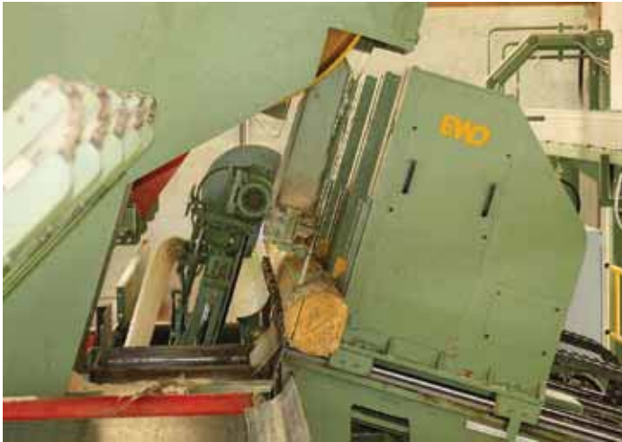
Eine Kapp- und Trennsäge schneidet die Seitenware auf die gewünschte Länge beziehungsweise Breite
