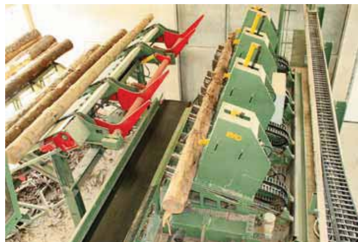
Rundholzaufgabe: Bis 8 m-Stämme kann der Spannagen mit vier Böcken aufnehmen
