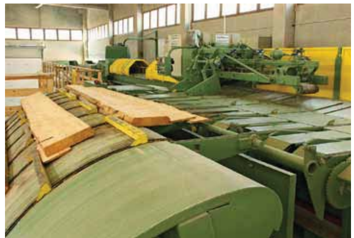
Die Besäumenanlage Optimes mit Vermessung im Längseinzug ist mit flexibler Trennsäge und Fixeinhang ausgestattet
