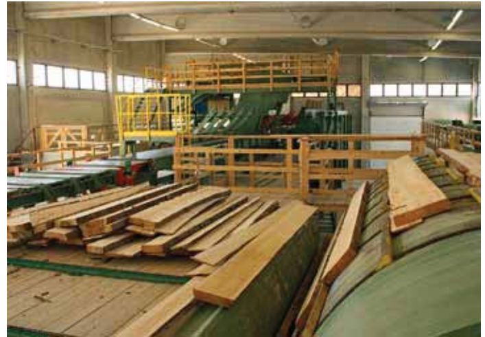
Bretter und Bohlen bis 100 mm Stärke werden mit einer Optimes-Anlage von EWD besäumt
