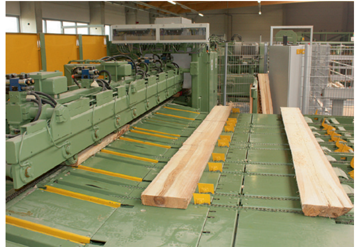
Übergabe der Mehrfachlängen auf den Einzug in Richtung Nachschnittgruppe mit Vermessung, Profispaner PF 19 und Doppelwellen-Kreissäge NKU 150
