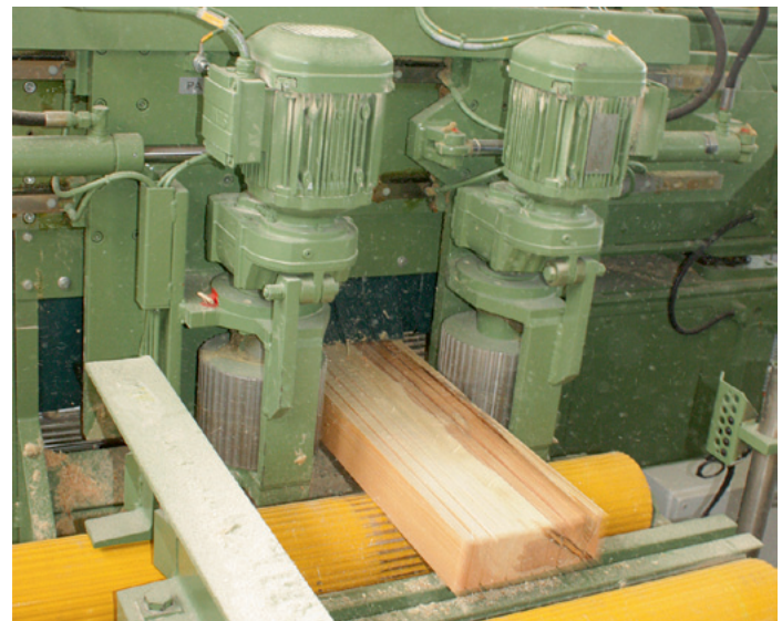
Fertig aufgetrennt: Die Palettenhölzer verlassen die NKU 150 und werden zur Stapelanlage transportiert
