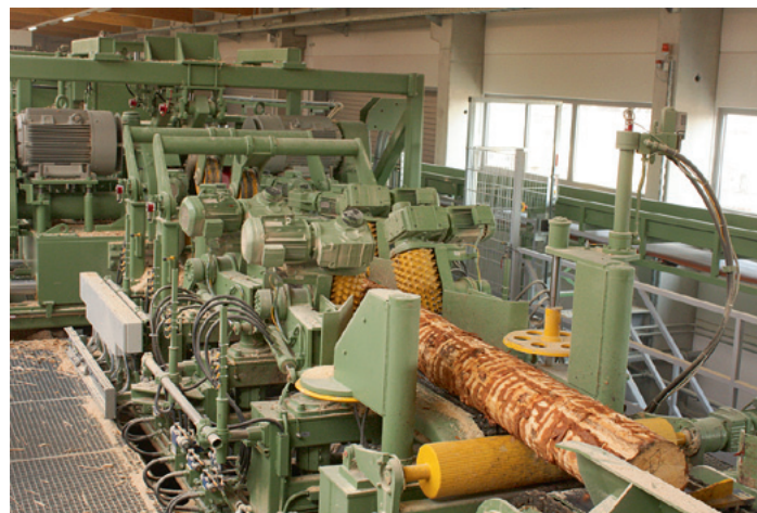
Vorschnittgruppe: Nach 2D-Vermessung folgt die Spaner-Kreissägen-Anlage, bis zu vier Seitenbretter können abgetrennt werden
