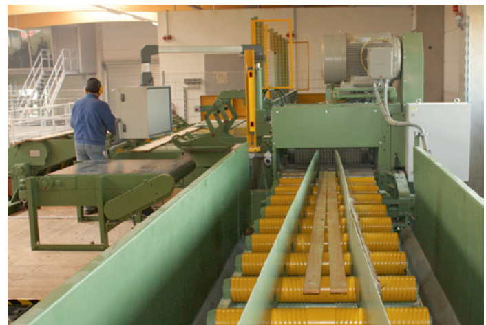
Die Seitenware wird mit dem Combimes DK90 besäumt und in Richtung Sortierung gefördert, die Spreißel werden automatisch separiert
