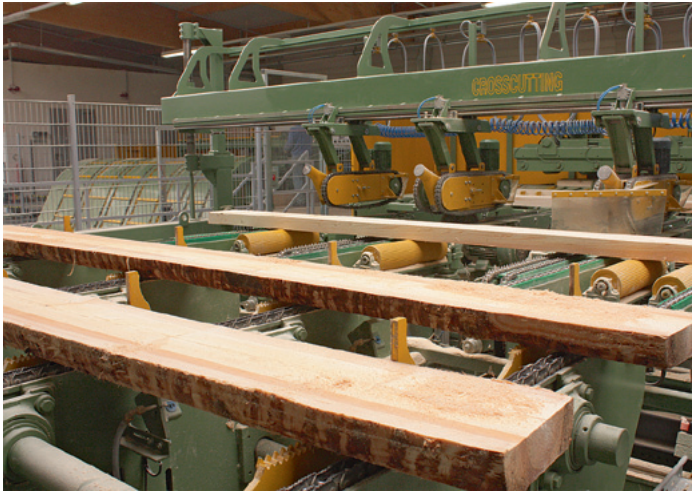
Mit einer Crosscutting-Säge werden die Model im Querdurchlauf bei Bedarf in bis zu drei Teile aufgetrennt
