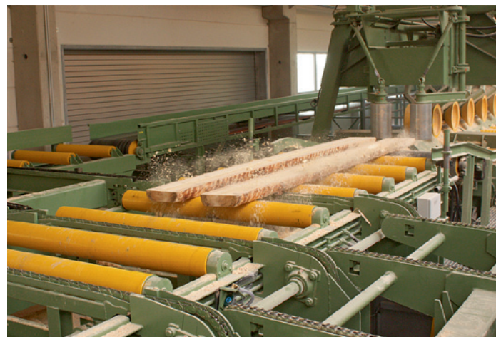
Model bis zu 150 mm Stärke werden im Vorschnitt aufgetrennt – in „Fahrtrichtung“ rechts wurde ein Rundlauf installiert
