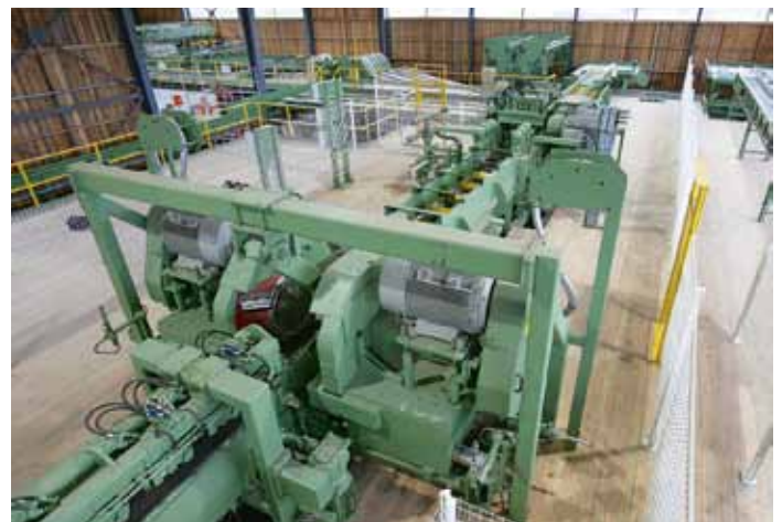
Optimierender Modelleinschnitt mit Spaner und Nachschnittkreissäge NKU 150
