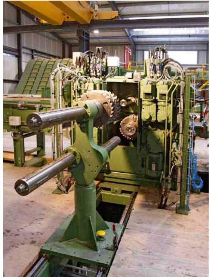
Mit der Nachschnittkreissäge NKU 150 bietet EWD eine spezielle Maschine für kurze Hölzer und Schnitthöhen bis 150 mm
