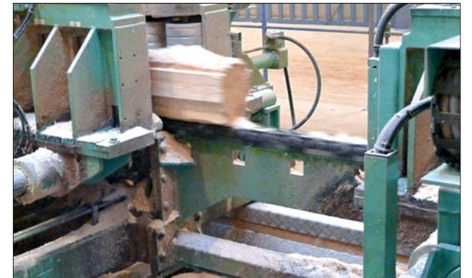
Model bei etwa 125 m Vorschub nach dem ersten Spaner. Deutlich erkennbar das asymmetrisch profilierte Seitenbrett.
