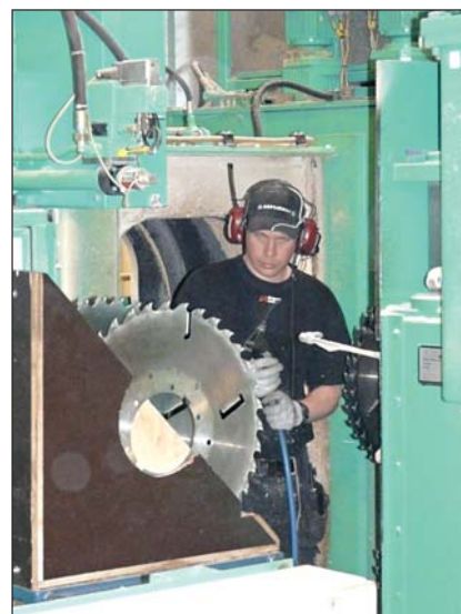
Werkzeugwechsel an der zweiten Seitenbrett-Kreissäge im hinteren Teil der Anlage.
