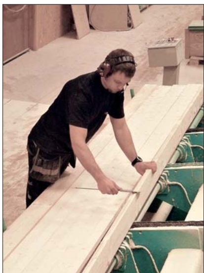
Zusätzliche händische Maßkontrolle an einer eigens dafür geschaffenen Ausschleusung.
